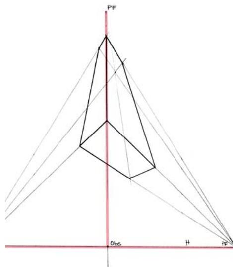
Figura 10. Perspectiva de tres puntos de fuga.
