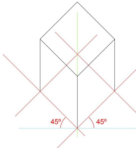
**Figura 4.** Perspectiva militar. En esta representación, el eje Z es el vertical, mientras que los ejes X e Y forman un ángulo de  $90^\circ$  que determina el plano horizontal que sirve para representar el suelo.
