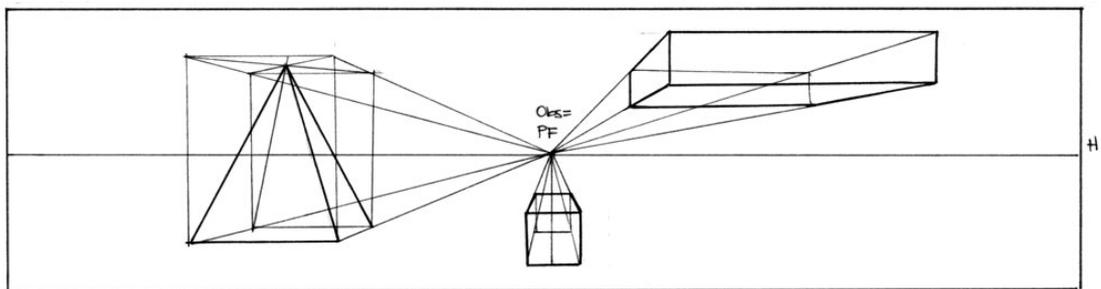
**Figura 8.** Perspectiva de un punto de fuga.
