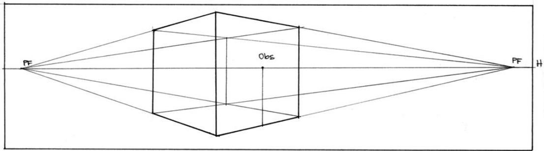
Figura 9. Perspectiva de dos puntos de fuga.
